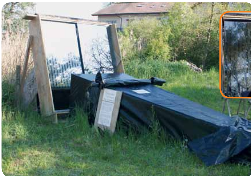
Essais dans un canal de vol installé dans le jardin de la Station ornithologique suisse, en collaboration avec Glas Trösch. Ici, on teste des marquages UV sur des vitres anti-solaires.
