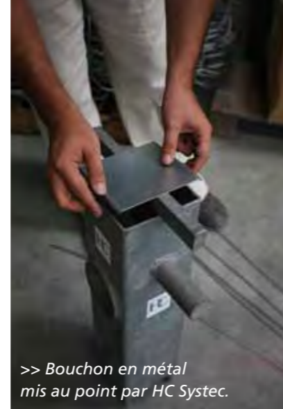
>> Filets anti-éboulements avec poteaux creux bouchés avec déchets plastiques.
