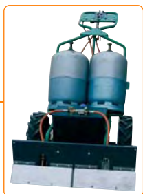
Désherbeur thermique à flamme directe, travail régulier sur grandes surfaces, modèle à rampe et à 2 bouteilles, Charoflam 186, 2EBALM
