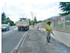
Utilisation du désherbeur thermique à eau chaude sur la commune de Bernin
