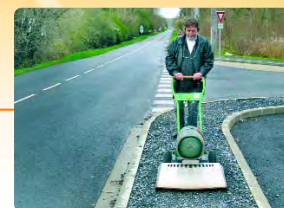
Désherbeur thermique à infrarouge modèle maniable et peu gourmand en énergie, TH 75, MME
