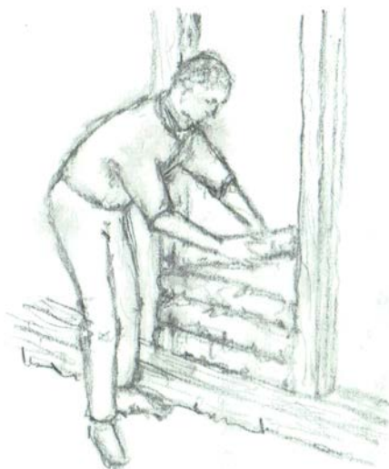
Illustration 29: Les fuseaux juxtaposés sont placés frais dans les cadres des colombages. Finition d'égalisation avec un enduit ou forme de torchis plaqué.
