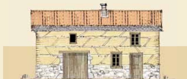
État initial d'une ferme en pisé.
