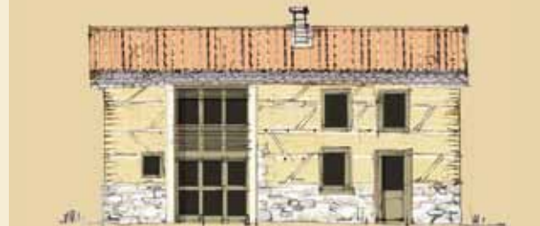
Proposition 2 : Des ouvertures verticales sur toute la hauteur du mur sont possibles, elles seront de préférence réalisées en continuité de l'existant. Des parties de mur en pisé très dégradées (fissure, ravine, effondrement) peuvent être également un endroit privilégié pour réaliser ce type d'intervention
