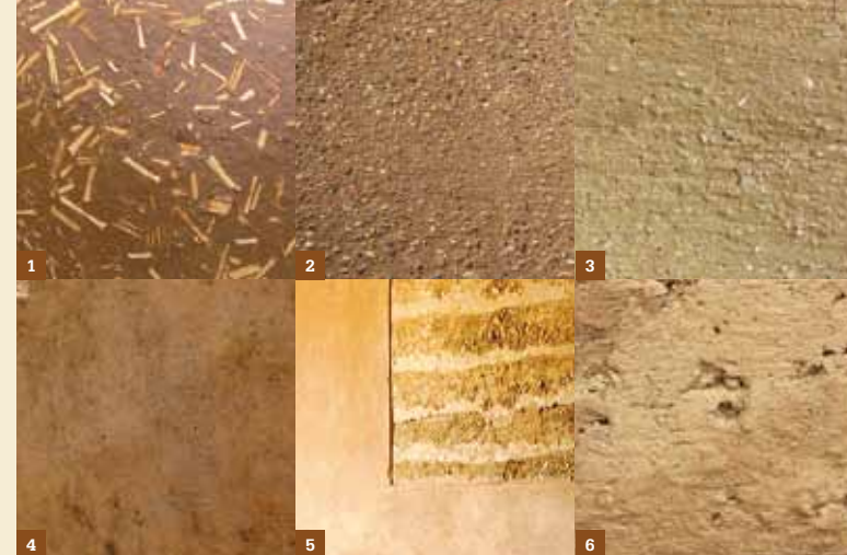
1. Terre/paille hachée - 2. Terre brossée - 3. Terre brossée - 4. Terre polie - 5. Terre talochée - 6. Badigeon de terre
