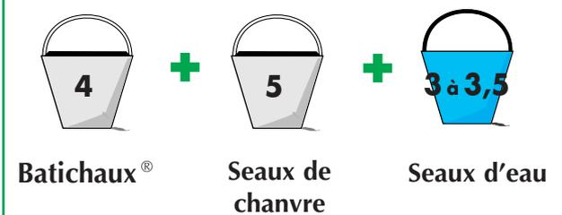
**Consommation au m<sup>2</sup>/5cm d'épaisseur en fonction du serrage : 38,5kg de liant et 55 litres de chanvre**
