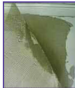
Le PRÉPENDUIT® est resté adhérent au support
