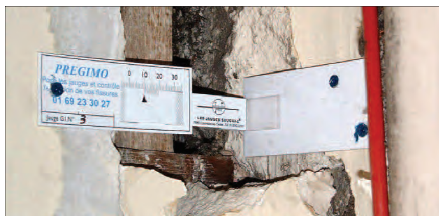
La cueillie présente des irrégularités. Pose d'une jauge G1 avec cornière plastique et plaque de renvoi
