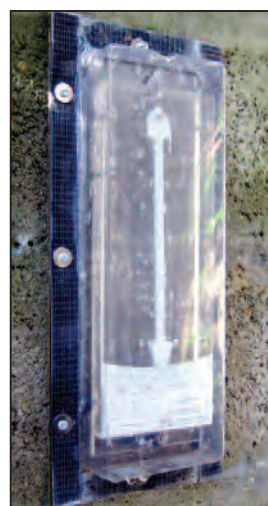
Capot plastique fixé par tap-vis
