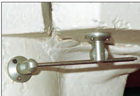
Analyse de l'évolution d'un joint de tassement
