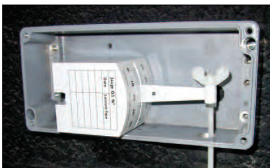
Protection d'une jauge G3 (Palais en Arabie Saoudite)
