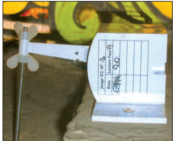
Utilisation d'un palpeur d'une longueur appropriée au désarasement
