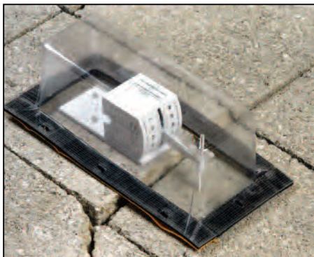
Pose d'une jauge G3 en extérieur avec capot transparent
